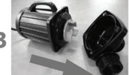
Schrauben vom Pumpengehäuse entfernen Schroeven van pomphuis verwijderen
