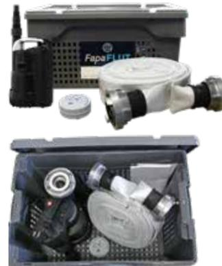
Die hochwertige Tauchmotorpumpe verfügt über einen integrierten Schwimmerschalter, der manuell festgestellt werden kann. Eine Absaugung ist bis zu 3 mm Wasserstand möglich. Die Pumpe verfügt über einen thermischen Überlastungsschutz und 10 m Anschlusskabel.
