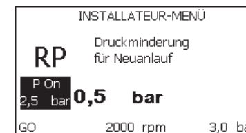
Abbildung 17: Einstellung des Neustartdrucks
