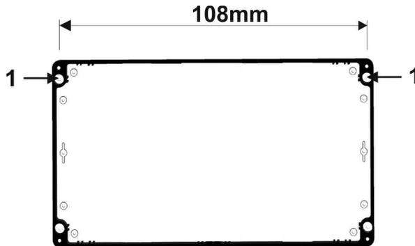
1: Gehäusebohrungen zur Befestigung des Gerätes
