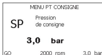
Figure 16 : Affichage d'un paramètre de menu
